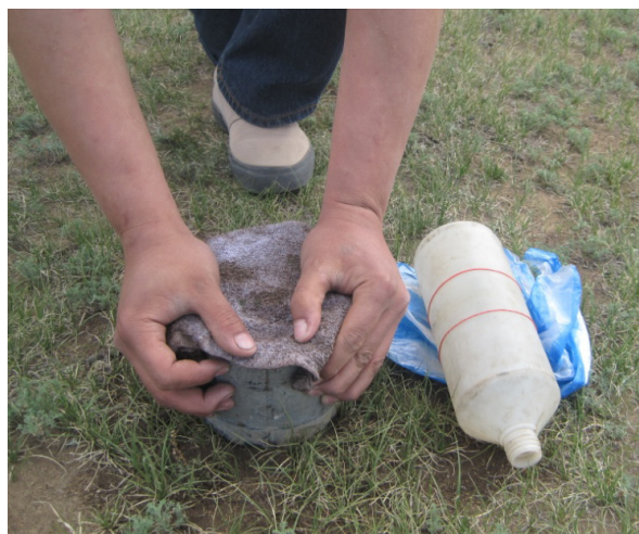
51 дүгээр зураг. Цагиргийг хөрсөнд 3 см гүнд шигтгэж байгаа байдал
