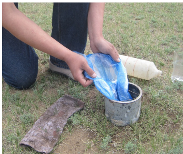
52 дугаар зураг. Цагирагт байрлуулсан нийлэг материал дээр усаа юүлж байгаа байдал
