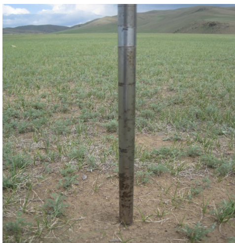
47 дугаар зураг. Пенетрометрийн конус хошууг хөрсний өнгөн үед далд ортол дарж оруулсан байдал.
