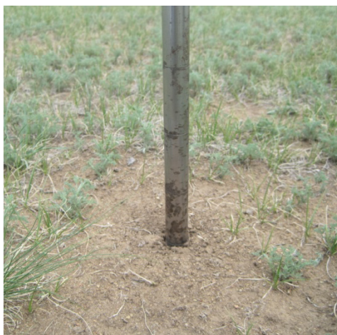
48 дугаар зураг. Пенетрометрийн гол дээрх хэрчлээс тутамд (5 см) алхны цохилтын нийлбэр тоог тэмдэглэж авна.
