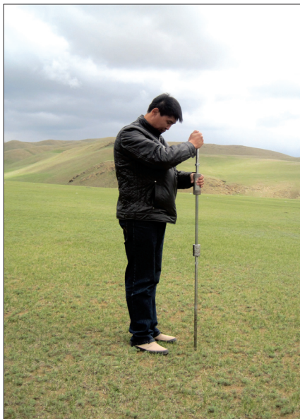
45 дугаар зураг. Цохилтын пенетрометр хэрэглэж хэмжилт хийхдээ алхыг өргөж байгаа нь
