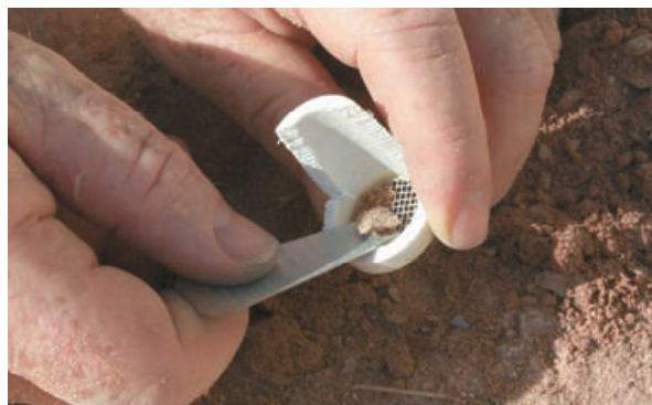
38 дугаар зураг. Шүүрэн дээр дээжийг байрлуулах байдал
