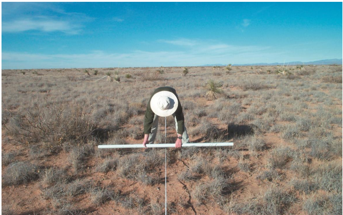
图 25 使 PVC 管的中心对准样线
