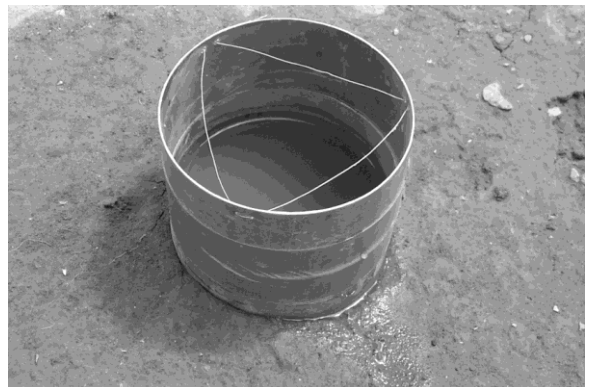
图 8.6 水从渗透环中渗漏
