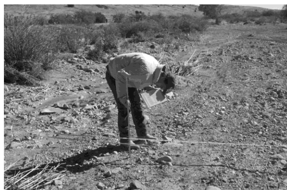
图 14.3 在跨越河道的测绳上每隔 50cm (1 或 2 英尺) 测量一次河道的深度
