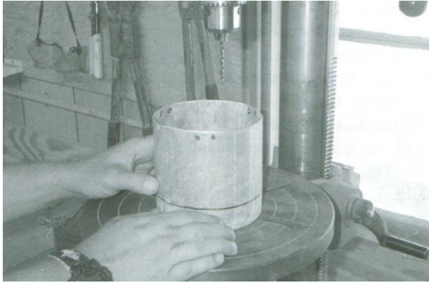
图 A.7 从环的顶部 1cm 处开始打 3 组孔，每组孔间相隔 5mm
