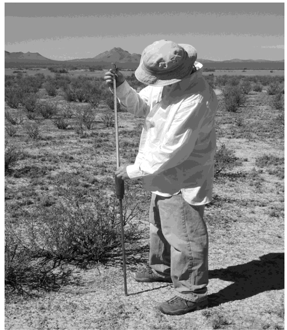
图 7.2 滑锤的高度是指滑锤到冲击板的距离
