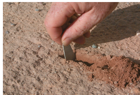
Figura 1. Excave una pequeña zanja.
